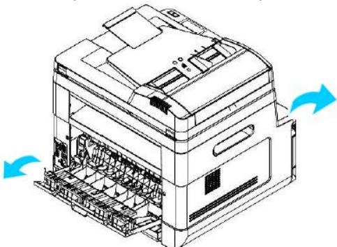
2. Откиньте вниз выходную направляющую узла термозакрепления.
