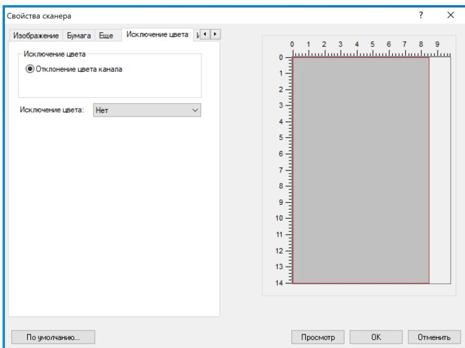
Функция позволяет отфильтровать цветовой канал. Например, если вы сканируете документ с красным водяным знаком, вы можете отфильтровать красный канал, чтобы на отсканированном изображении был только текст, а не красный водяной знак.
