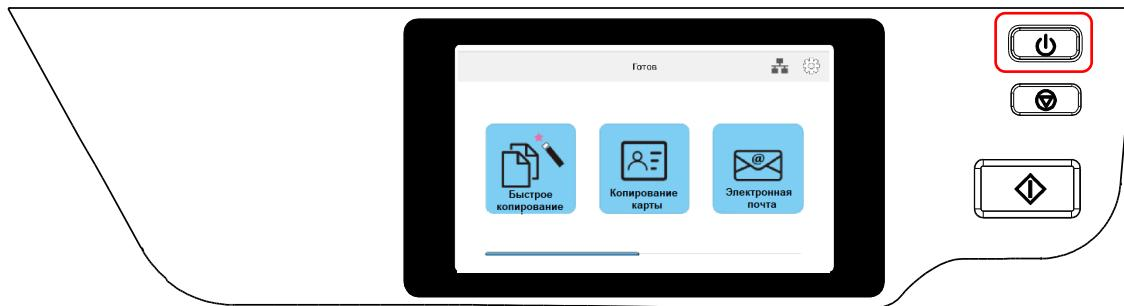
Чтобы выключить устройство, нажмите и удерживайте кнопку питания в течение трех секунд – светодиодный индикатор в кнопке питания погаснет, устройство выключится.
