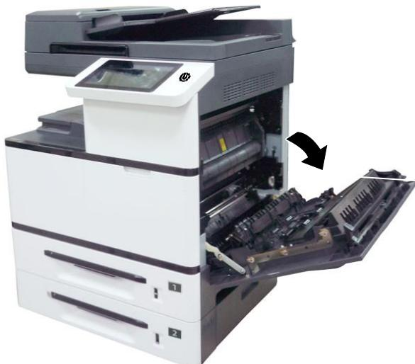
**8.** Снимите фиксирующую скобу, нажав на клавишу одной рукой и потянув скобу другой рукой, как показано на рисунке ниже, а также вытащите инструкцию к ней.
