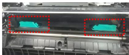
**9.** Поверните защелку направляющей бумаги против часовой стрелки, чтобы вернуть ее в исходное положение.
