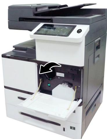
2. Извлеките тонер-картридж из упаковочного пакета и снимите с него защитную ленту. Наклоните картридж вверх-вниз, а затем вправо-влево несколько раз, чтобы равномерно распределить тонер внутри картриджа.
