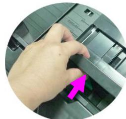
**5.** Нажмите с боков на направляющую длины бумаги и сдвиньте направляющую до размера загружаемой бумаги.
