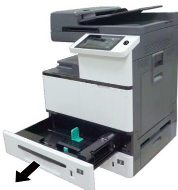
4. Нажмите на фиксатор передней направляющей ширины бумаги и сдвиньте направляющие до размера загруженной бумаги.
