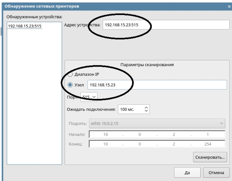
6. После сканирования, выделяем найденный аппарат и нажимаем «Да»
